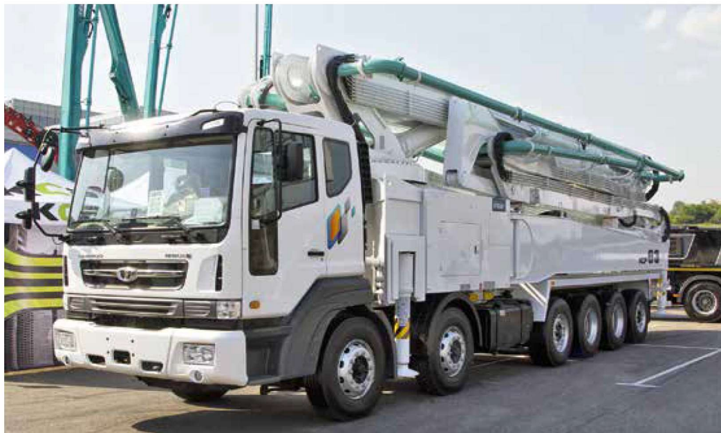
Бетононасос КСР 63 на шасси Daewoo Novus SE12x4
