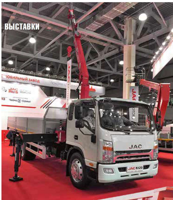
JAC N120 (N721) мод. 47161F «Нижегородского автомеханического завода» с КМУ Unic V370
