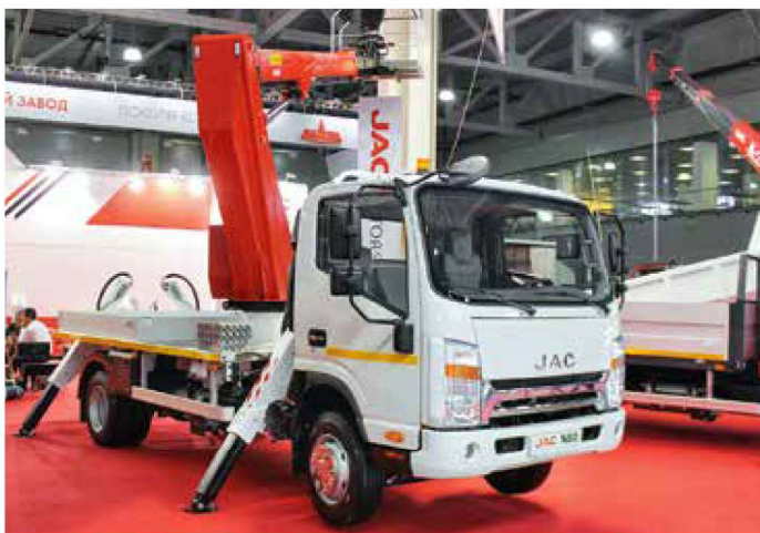
JAC N80 (N721) мод. 47882H 000 «Автомеханический завод» с автогидроподъёмником Palfinger P180T
